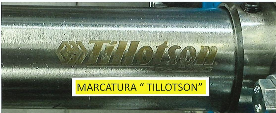
**2.3 Dimensioni:  $\varnothing 50 \times 2 \times 1030 \text{mm}$ . Non è consentito accorciare l'asse. Lunghezza totale 1030mm.**
